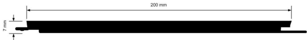
**Material:** Vollmaterial geschäumt / Oberfläche: Hart-PVC bleifrei stabilisiert (Ca-Zn)
